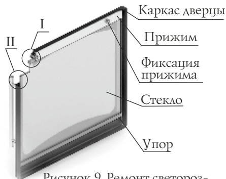
Рисунок 9. Ремонт светорозрачного экрана двери модели «Витра»
